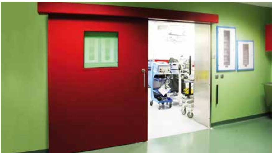
Porta PONZI PSE IVC - Full Clad con finitura in acciaio inox verniciato RAL - Sala lavaggio
